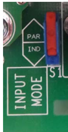
Figure 3-14: S1 Switch in PAR position (parallel mode)
