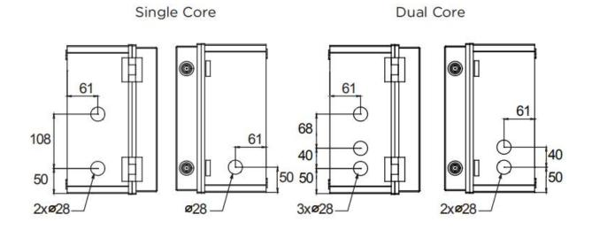
Drilling Guide for 1" Conduit
